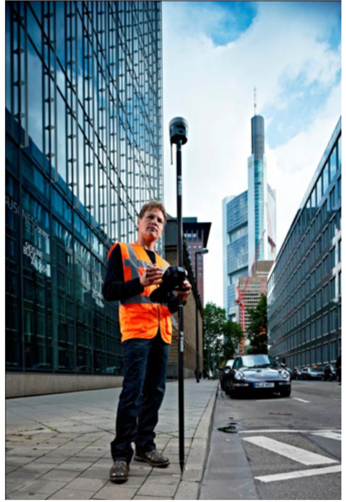
Figure 3 : récepteur Trimble R10 doté de la technologie Trimble 360 utilisé en zone urbaine
