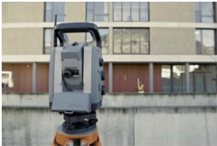
Figure 12. Utilisation de Trimble Access pour mesurer à distance des points sur le terrain
