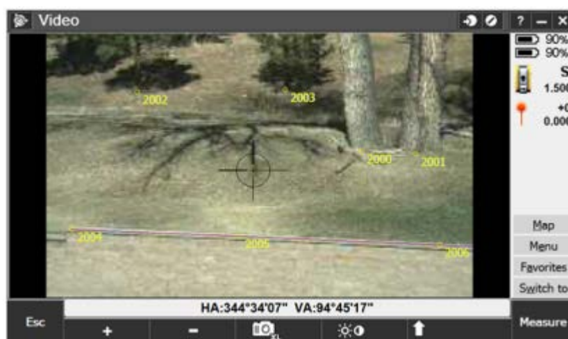
Figure 13. Trimble Access superpose le réticule et les données de levés au flux vidéo
