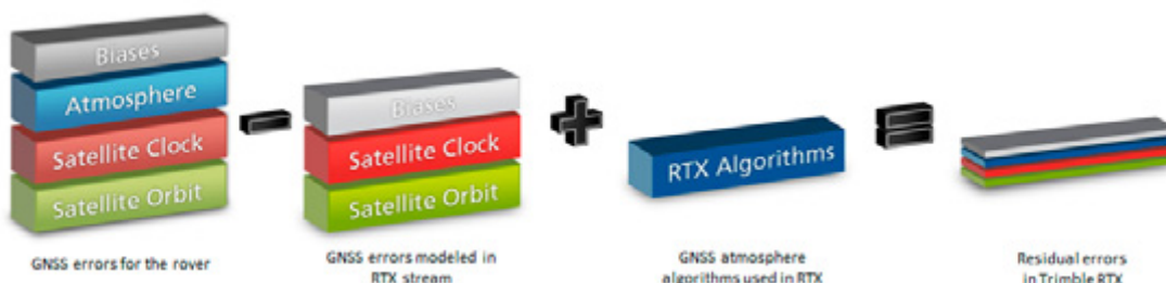
Figure 8. Modélisation des erreurs par Trimble RTX
