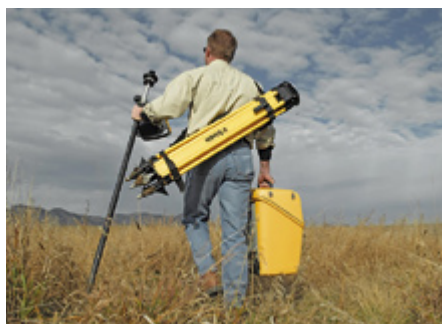
Topographie – dans le mode Robotique – une personne peut mesurer et enregistrer des points aussi rapidement qu'elle peut se déplacer à pied.
