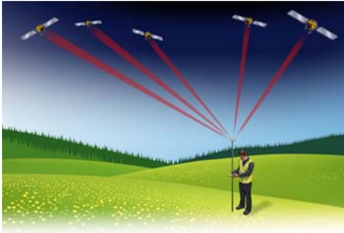
Figure 1. Trilatération des distances des satellites pour estimer la position d'un récepteur autonome
