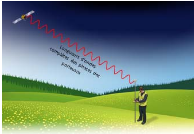
Figure 3. L'ambiguïté de nombre entier est le nombre inconnu de longueurs d'onde complètes de la phase de la porteuse entre le mobile et chaque satellite.
